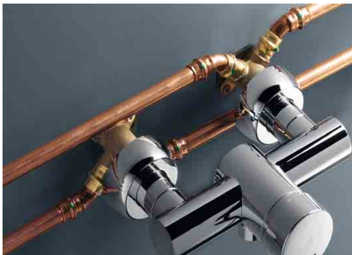
Optimal ist das automatische Spülsystem endständig am Ende einer durchgeschleiften Reihen- oder Ringleitung (hier mit hygienisch optimalen Doppelwandscheiben) platziert.
