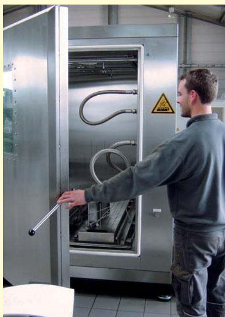
Prüfkammer für Fahrzeugteile, Beanspruchung auf Temperatur, Druck, mechanische Kräfte
