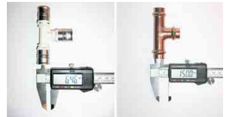
Das Innere eines Fittings, über 50 % Flächenreduzierung bei den Mehrschichtverbund-Formstücken
