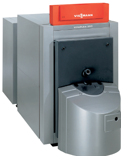
③ Niedertemperatur-Heizkessel Vitoplex 300 mit nachgeschaltetem Abgas-/Wasser-Wärmetauscher Vitotrans 300 zur Brennwertnutzung
