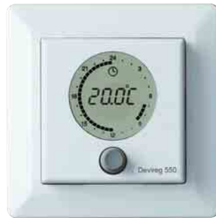
Zur Regelung gehört der selbstanpassende UP-Uhrenthermostat devireg 550 mit LCD-Display. Einstellbar sind die Betriebsmodi „Nur mit Bodenfühler“, „Nur mit Raumfühler“ oder als Doppelthermostat „Mit Boden- und Raumfühler“.
