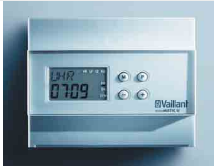
Die wicoMATIC von Vaillant steuert die Aufladung von Speicherheizgeräten oder Zentralspeichern vollautomatisch und witterungsabhängig. Sie erkennt die Tendenz des Verlaufs der Außen-temperatur.
