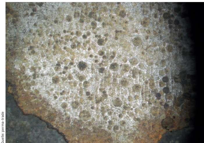
1 - Lochkorrosiver Angriff von Sauerstoff an einer Kesselwand aus Schwarzstahl - mit Wanddurchbruch - im diffusionsoffenen System einer älteren Flächenheizung nach weniger als zwei Jahren
