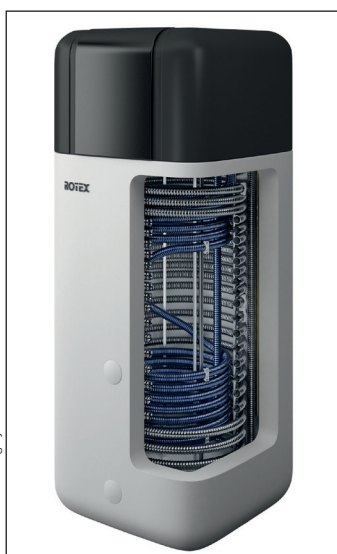
Für optimale Wasserhygiene setzt ROTEX auf einen Edelstahl-Wellrohr-Wärmetauscher, der das Trinkwasser im Durchlaufprinzip erst während der Entnahme erwärmt.
