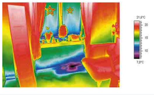
Kalt erwischt: Eine offene Anschlussfuge unter einer Fußleiste führt zu kalten Füßen im Wohnzimmer.
