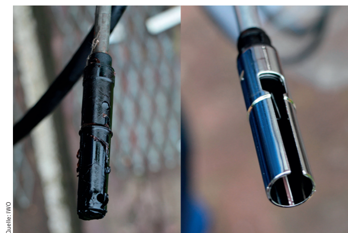
Quelle: IWO Während der Grenzwertgeber alter Bauart (links) zwei Bohrungen in der Schutzhülse hat, ist beim neueren Modell ein Schlitz eingearbeitet, der weniger verschmutzungsanfällig ist.
