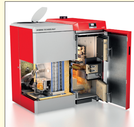
Die Hersteller gehen unterschiedliche Wege, die Kombinationsfrage zu lösen. Manche (wie hier im Bild Windhager mit seinem „DuoWin“) lösen sie über zwei eigenständige Kessel, die über eine Regelung verbunden werden.
