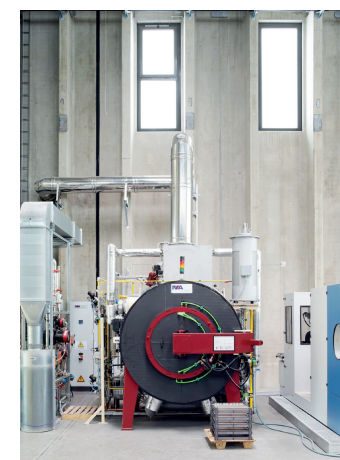
Hochtemperaturofen zum Härten der Werkstücke innerhalb der Musterproduktionskette
