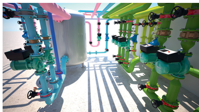
Realitätsgetreue Visualisierung der Kältezentrale mit millimetergenauen Herstellerbauteilen
