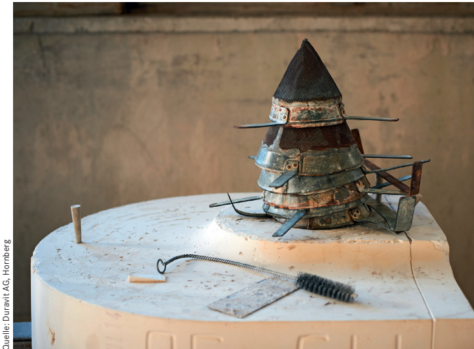
1 - Die Rohstoffe werden mit Wasser zum so genannten Schlicker verarbeitet und durch Gießpumpen in die Gipsformen eingefüllt.
