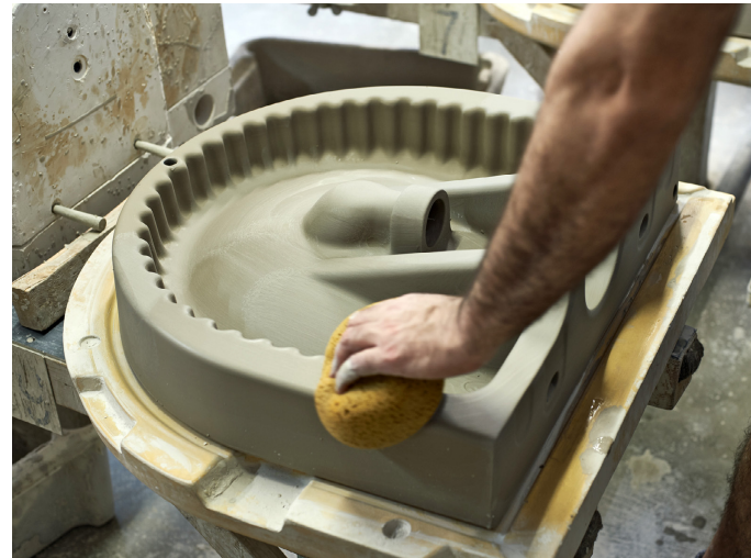
2 - Nach etwa einer Stunde ist der Formling gehärtet und wird zum weiteren Trocknen aus der Form genommen.
