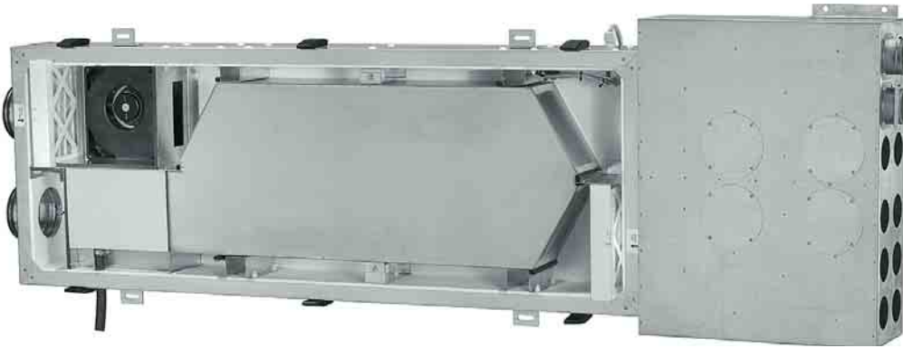
Die komplexe Technik eines modernen, zentralen Lüftungsgeräts, hier der Zehnder Comfoair flat 150: Ganz rechts der optionale Schalldämpfer mit integrierter Montageplatte und den Ab- und Zuluftöffnungen. In der Mitte der Wärmetauscher, der rechts unten vom Abluftfilter sowie links oben vom Pollenfilter eingerahmt wird. Neben dem Pollenfilter sitzt der Gleichstrom-Ventilator mit 48 V.
