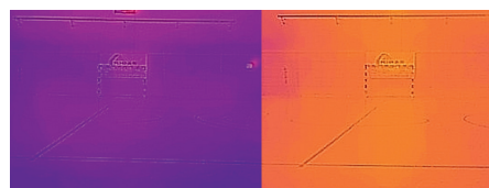
Der jeweils eingeschwungene Zustand der Raumtemperatur blau abgesenkt – orange Zieltemperatur
