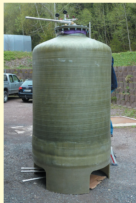
5 – GFK-Speicher mit einem Fassungsvermögen von 2 m 3
