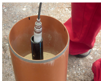
Mit Hilfe eines Sensors, der Meter für Meter in die Erdwärmesonde (hier zur Demonstration nur ein einfaches Rohr) eintaucht, lässt sich die Qualität der Suspension messen.
