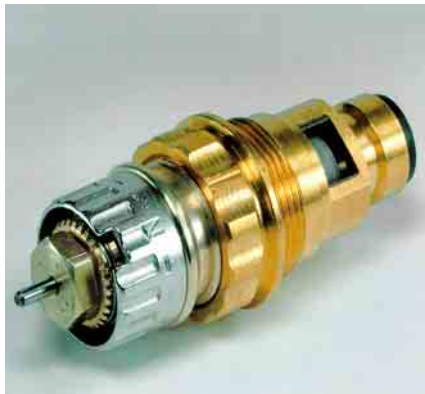
④ Die voreinstellbaren Danfoss Ventileinsätze lassen sich bei 20 bis 30 Jahre alten RAV- und RAVL-Ventilgehäusen leicht nachrüsten. Der Austausch erfolgt schnell und ohne Demontage des kompletten Gehäuses.
