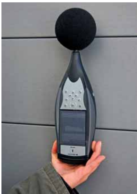
2 – Für Messungen sollten Geräte der Genauigkeitsklasse 1 verwendet werden, damit exakte Werte für die Berechnung ermittelt werden.
