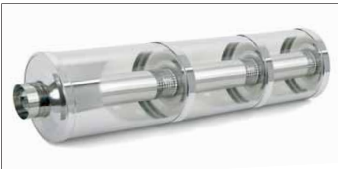
5 – Der Tieftonschalldämpfer im Aufbau: Je nach Größe und Anzahl der Kammern werden bestimmte Frequenzen gefiltert.
