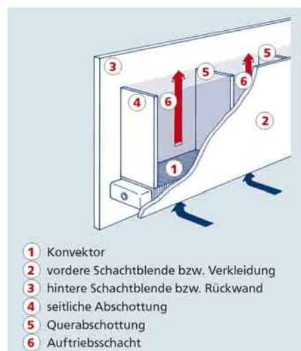
4 Kaminförmiger Schacht mit Querabschottung oberhalb eines Konvektors
