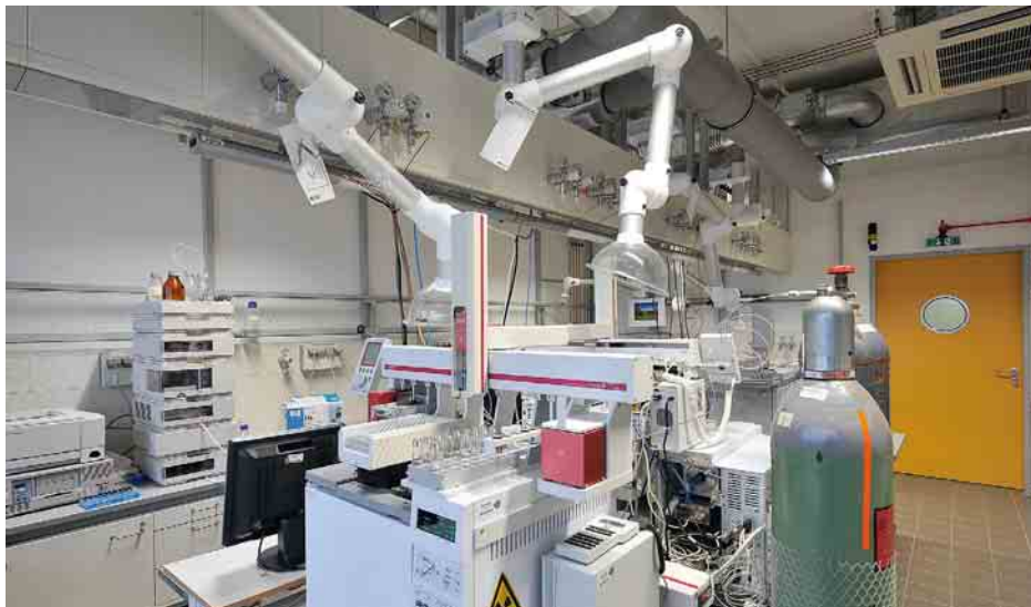
In den Laborräumen herrscht ein geringer Unterdruck. Damit ist gewährleistet, dass Keime nie nach außen gelangen können. Den hohen Hygieneanforderungen wird man mit einem ständigen Luftaustausch gerecht.
