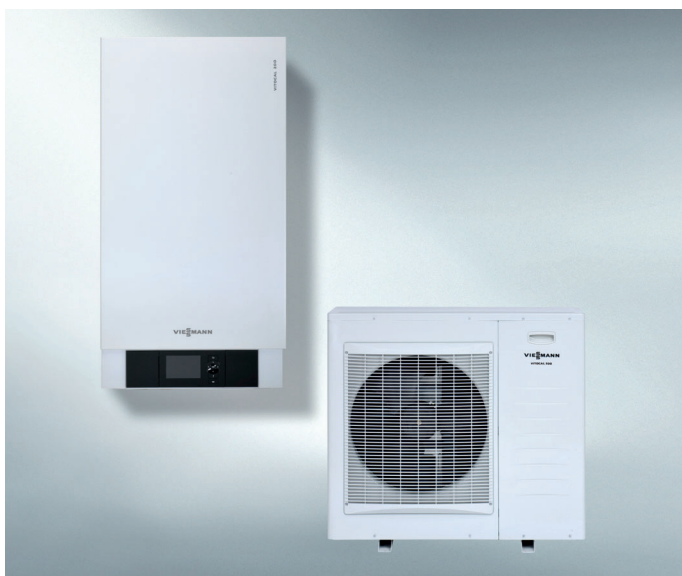
4 – Moderne Split-Wärmepumpe (Vitocal 200-S) mit invertergesteuertem Verdichter und elektronischem Expansionsventil (COP bis 4,6 nach EN 14511 bei A 7 °C/W 35 °C)
