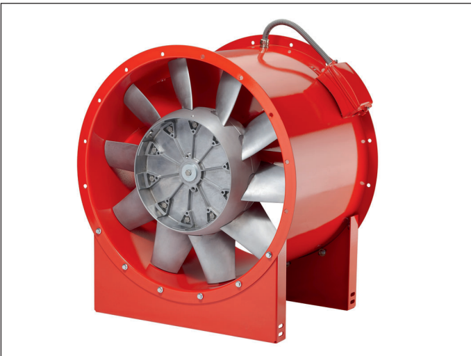
Einsatz von Axial-Mitteldruckventilatoren im zu entrauchenden Bereich. Hier: Helios B AMD für Volumenströme von 3.000 bis 70.000 m³/h und Feuerwiderstandsklasse F300/F400
