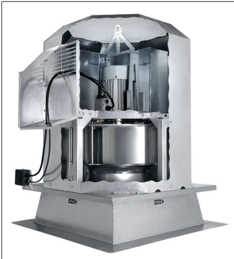
Rauchabführung über Dachventilatoren. Hier: Helios BDV in den Größen Ø 315 bis 710 mm für Förderleistungen von 3.700 bis 40.000 m³/h
