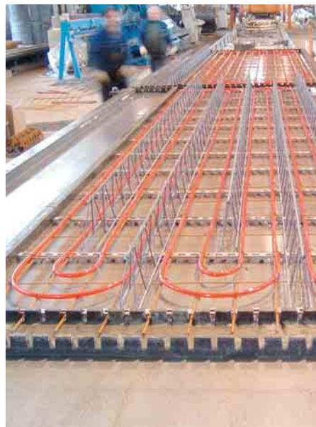
5 Integration der BKT von REHAU in Elementdecken im Betonwerk
