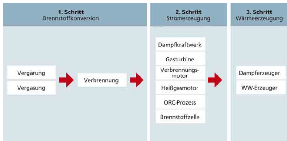
1 Prozessschritte bei der Kraft-Wärme-Kopplung
