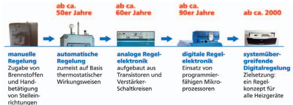
1 Die Geschichte der Regelungstechnik: von der manuellen Einzelregelung zur systemübergreifenden Digitalregelung
