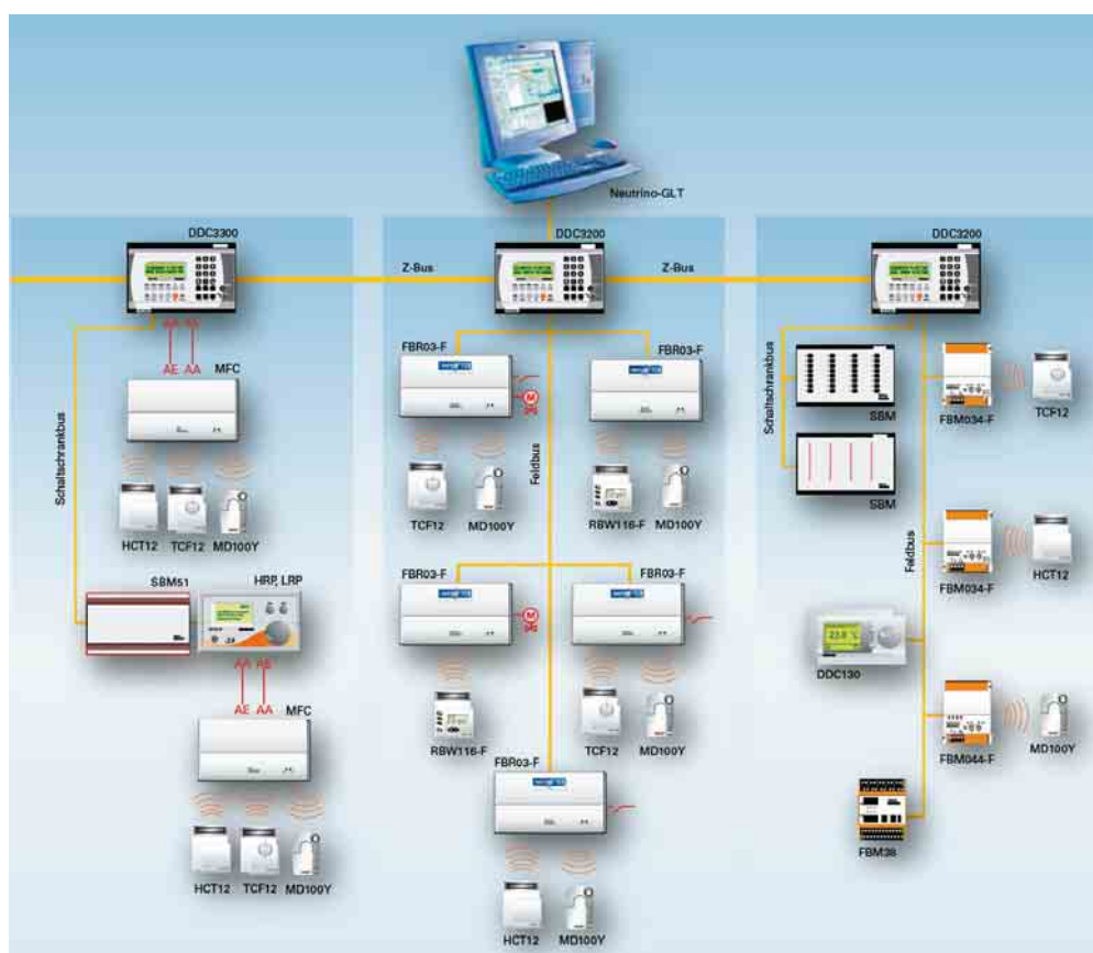
② Die technolink-Komponenten: HCT12: SolarFunk-Messwertgeber für Raumfeuchte; TCF12: SolarFunk-Messwertgeber für Raumtemperatur; MD100Y: funkgesteuerter Stellantrieb; MFC: zentraler Funkumsetzer; FBR03-F: funkfähiger Raumcontroller; RBW116-F: SolarFunk-Raumbediengerät; FBM034-F: funkfähiges Ein-/Ausgabemodul; FBM044-F: funkfähiges Ein-/Ausgabemodul
