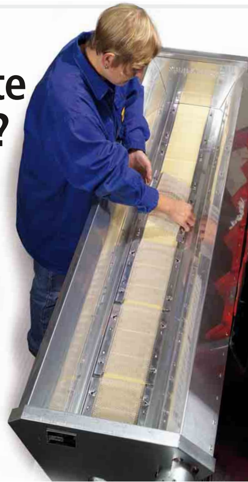
Die Produktion eines Hellstrahlers erfordert Sorgfalt und Handarbeit, wie hier das Einsetzen der Strahlungsgitter. Schön zu sehen: die polierte Aluminiumoberfläche der Blenden. Sie weisen einen höheren Strahlungswirkungsgrad auf als Edelstahl.
