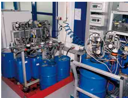
5 Alle Ergebnisse der Versuchsreihen mit verschiedenen Bioheizölmischungen, beispielsweise in den Pumpenprüfständen, flossen in die Vornorm ein.
