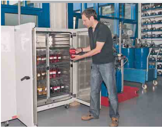
4 Bioheizöle durchlaufen zurzeit umfangreiche Untersuchungen in Hochschulen, Forschungseinrichtungen und Feldanlagen. Unter anderem konzentrieren sich die Tests (hier am Aachener Oel-Wärme-Institut) auf die Lagerungsstabilität von Heizöl mit unterschiedlichen Anteilen aus nachwachsenden Rohstoffen.
