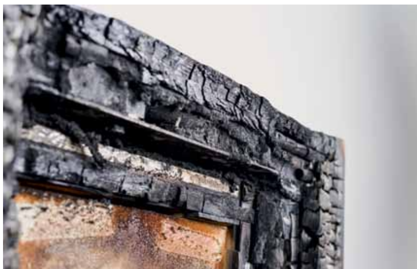
PRÜFKÖRPER nach erfolgreicher Brandprüfung
