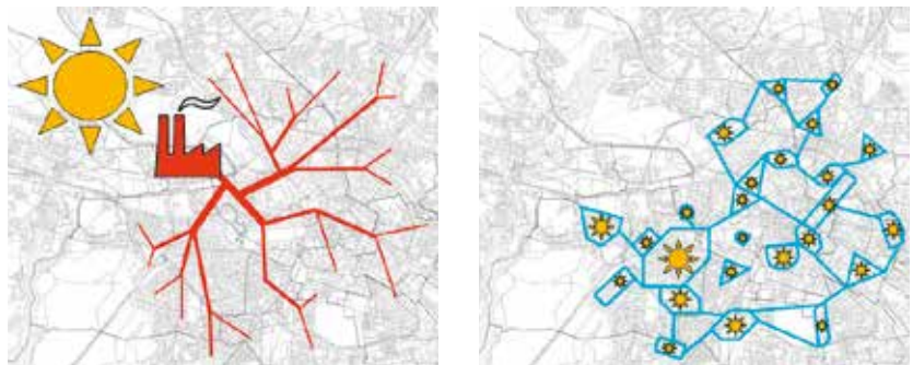
Zentralistische und maschenförmige Vernetzung. Links: Wärme war ursprünglich ein „Abfallprodukt“ der Stromerzeugung. Rechts: Umweltenergie fällt dezentral an, Wärmebedarf entsteht dezentral.
