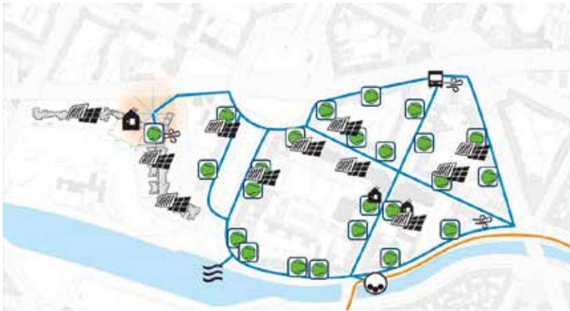
Maschenförmige Vernetzung von Quellen, Senken und Speicher im 5GDHC-Netz
