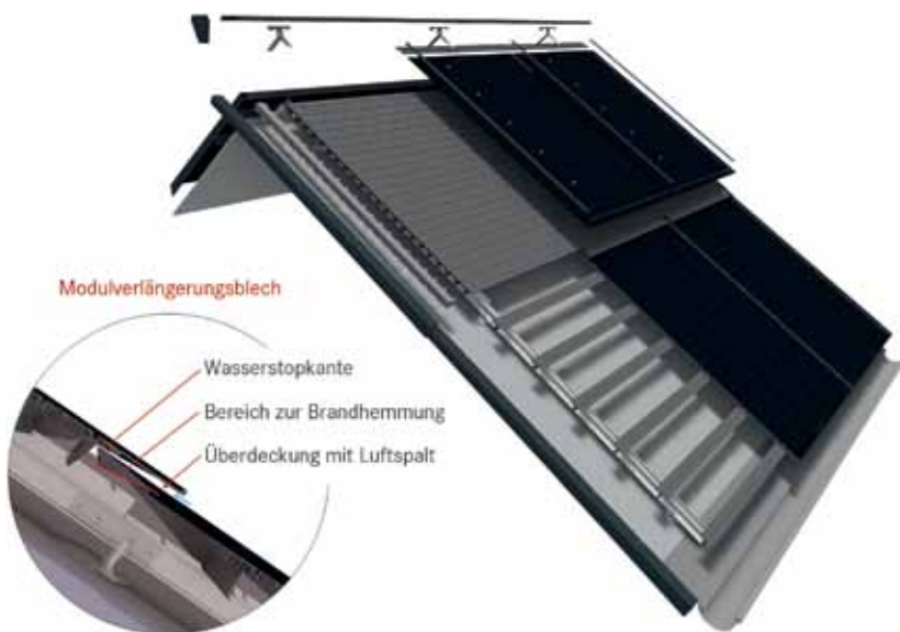
Gebäudeintegriertes PVT-System der Firma nD-System – Explosionsgrafik
