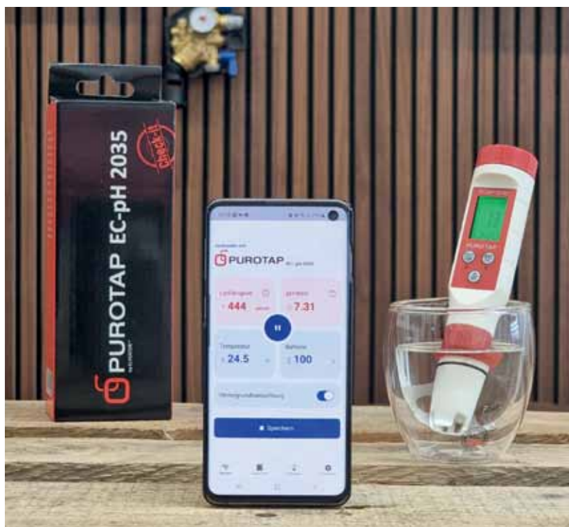
In der kostenlosen Smart-App des Kombimesegerätes Purotap EC-pH 2035 kann die jeweils gültige Normeinstellung gewählt werden.
