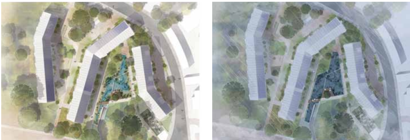
④ Lageplan der Anlage ohne Maßstab: Links das Teichsystem bei Trockenheit im Regelbetrieb, rechts mit maximalem Wasserstand während eines Starkregens.
