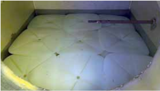
③ Links: Blick in einen hybriden PCM-Versuchsspeicher, während des Beladevorganges mit PCM-O, HeatSel XL /6/. Rechts: Beispiel für eine industrielle Ausführungsvariante /4/ eines hybriden PCM-Speichers
