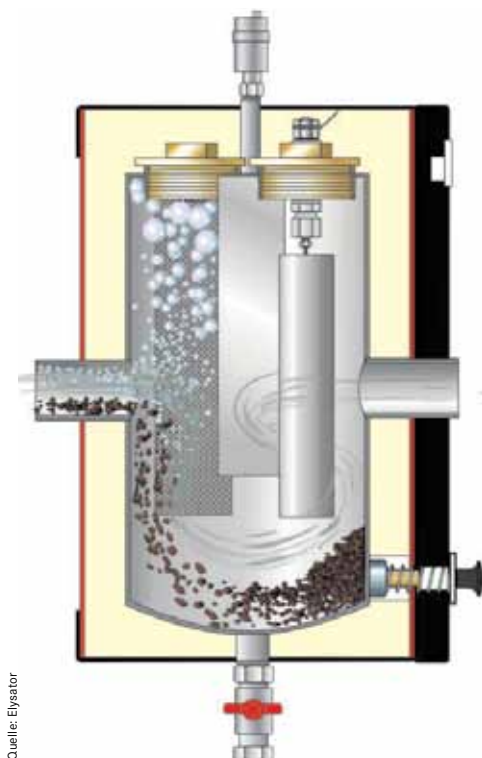
Schnittmodell und eine halb verbrauchte Schutzanode eines Elysator Trio 10-Gerätes
