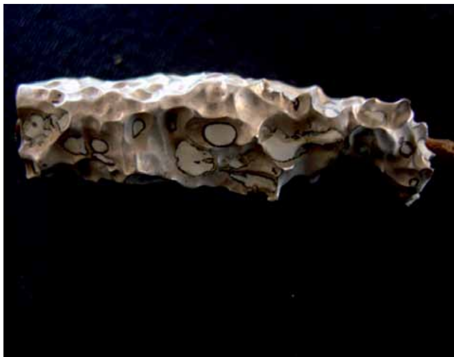
Schnittmodell und eine halb verbrauchte Schutzanode eines Elysator Trio 10-Gerätes
