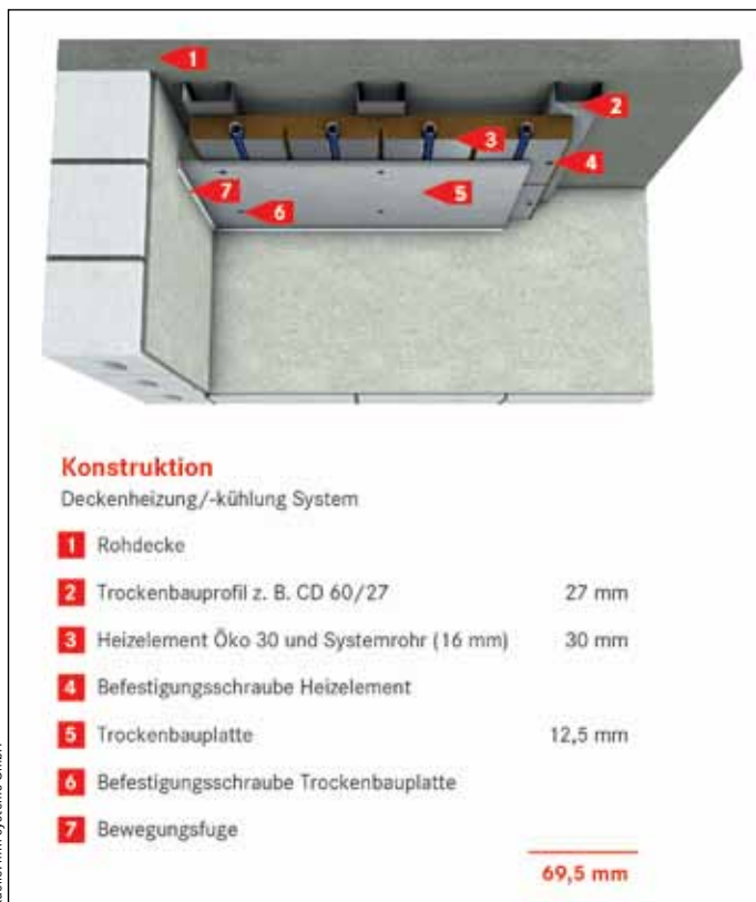
Konstruktion: Komplett Konstruktio n von Ideal Classic Öko in Verbindung mit Trockenbauprofilen
