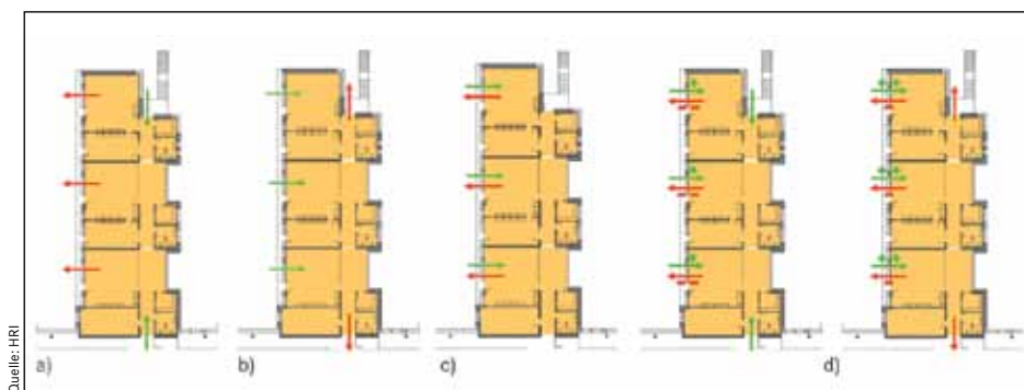
2 – Vier verschiedene Lüftungsfälle in benachbarten Räumen, a) nur Abluft, b) nur Zuluft, c) Zu- und Abluft, d) Zu- und Abluft mit variierenden Geschwindigkeiten
