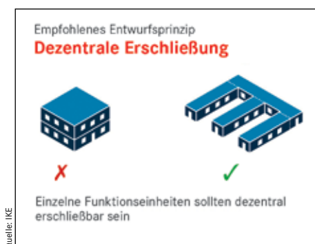
3 – Darstellung Entwurfsprinzip dezentrale Erschließung, ermöglicht die Bildung von Kohorten.
