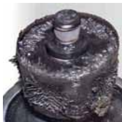
② Moderne Nassläuferpumpen reagieren sensibel auf Magnetit im Anlagenwasser.
