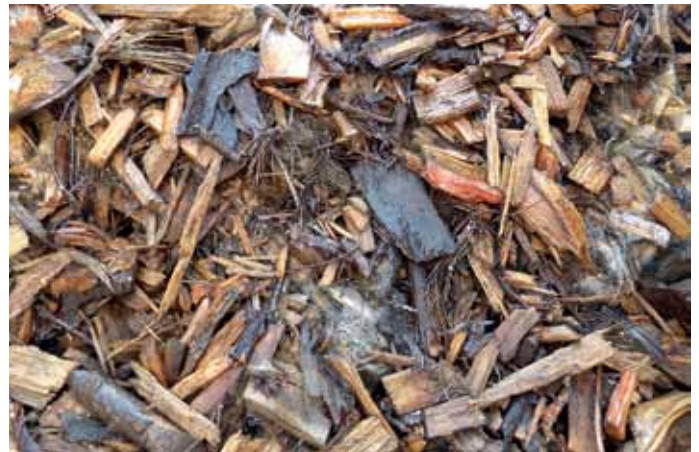
Schlechte Lagerbedingungen führen zu einer Zersetzung der Brennstoffe und damit zu hohen Trockenmasseverlusten und einer Verschlechterung der Brennstoffqualität.
