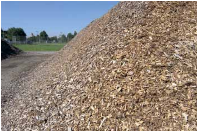
Hackschnitzellagerung im Sommer am Stadtrand von Straubing. Grob gehackte Holzhackschnitzel mit geringem Fein- und Grünanteil bieten gute Voraussetzungen für die Lagerung.
