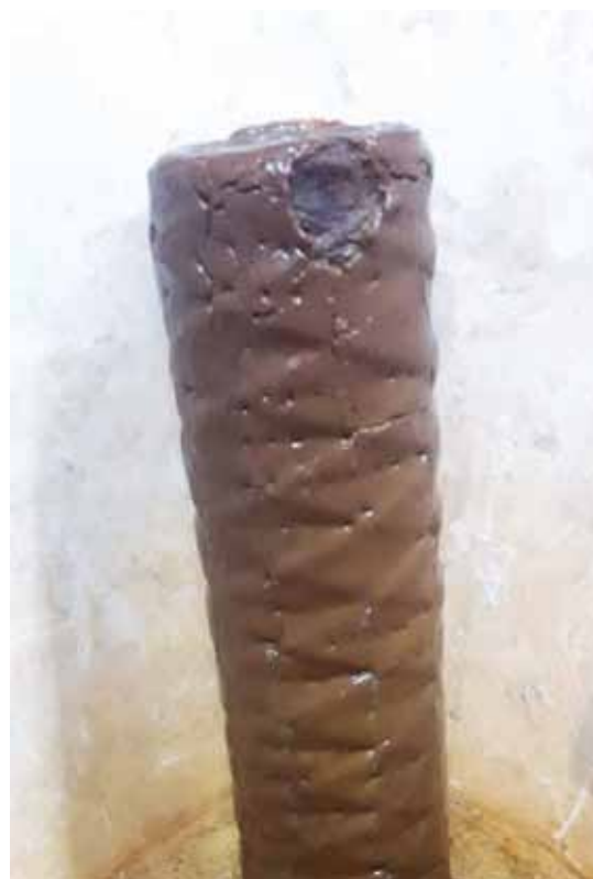
5 – Wird saures, stark eisenhaltiges Anlagenwasser direkt in den von den Richtlinien geforderten Bereich (8,2–10,0) alkalisiert, fallen Eisenoxidhydrate aus, welche Filterkerzen schnell verblocken können.
