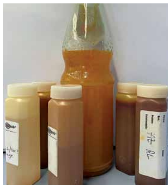
1 – Proben von Heizungswasser, wie sie im Labor-Alltag des Öfteren vorkommen. Häufig sind die Heizungswässer unmittelbar bei der Probenahme nur leicht gefärbt, bei Sauerstoffzutritt fallen dann 3-wertige Eisenkorrosionsprodukte aus.
