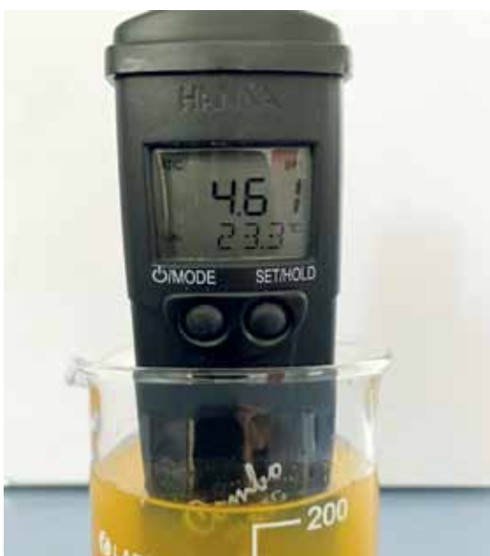
4 – Anlagenwässer, die durch eingebrachte Reste von Frostschutzmitteln verunreinigt sind, zeigen einen auffallend niedrigen pH-Wert. Grund dafür sind organische Säuren, die als Abbauprodukt aus Glykolen entstehen.
