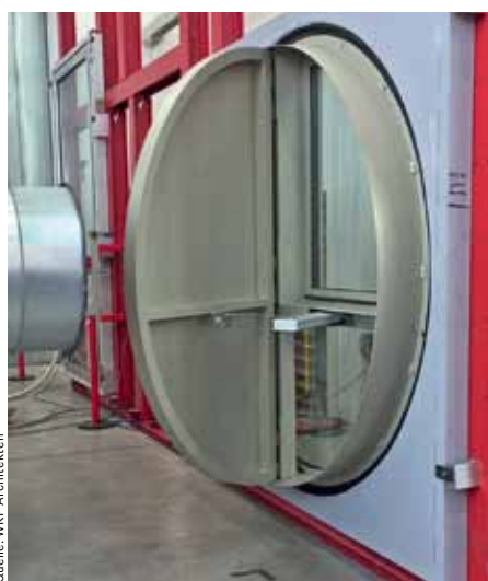
Versuchsaufbau des Windtests, in dem die Fensterläden zusammen mit dem Klapparm² Antrieb mit einer simulierten Windgeschwindigkeit von 24 m/s (= 86,4 km/h) geprüft wurden.
