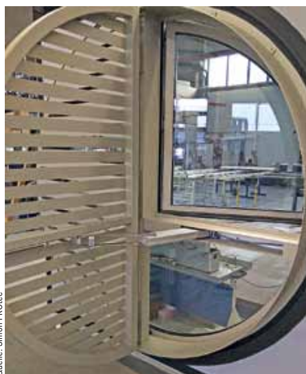
Ein Muster des Rundfensters mit dem IP 65 Klapparm² Antrieb von Simon PROtec.
