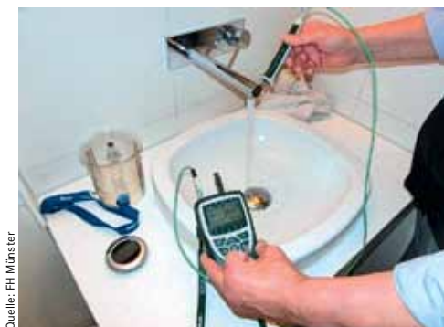
4 – Messung von Zapfprofilen mit einem Sekundärthermometer an einer Entnahmestelle
