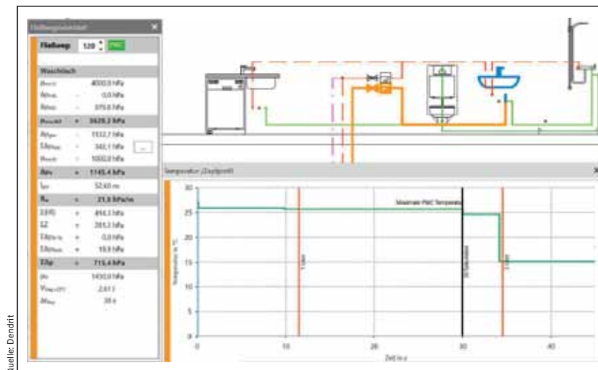
11 – Zu erwartende mittlere Temperaturen im Luftverbund Schacht/Vorwand in Abhängigkeit von der Schachtbelegung, bei Raumtemperaturen, die bei der Heizlastberechnung zu Grunde gelegt werden.
