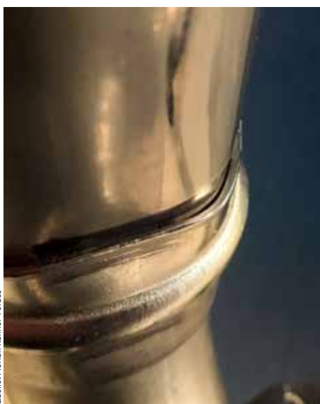
3 – Aufwerfung der Fittingmuffe bei Sechskantpressung mit Bildung eines Kapillarkanals
