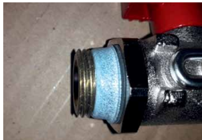
5 – Selbstdichtende Verschraubung eines Kugelventils
